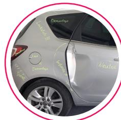
Verbesserung der Kostenvoranschläge durch Standardprozess in der Schadenaufnahme inkl. Checkliste, Standardfotos und Markierungen mit Kreidestift
